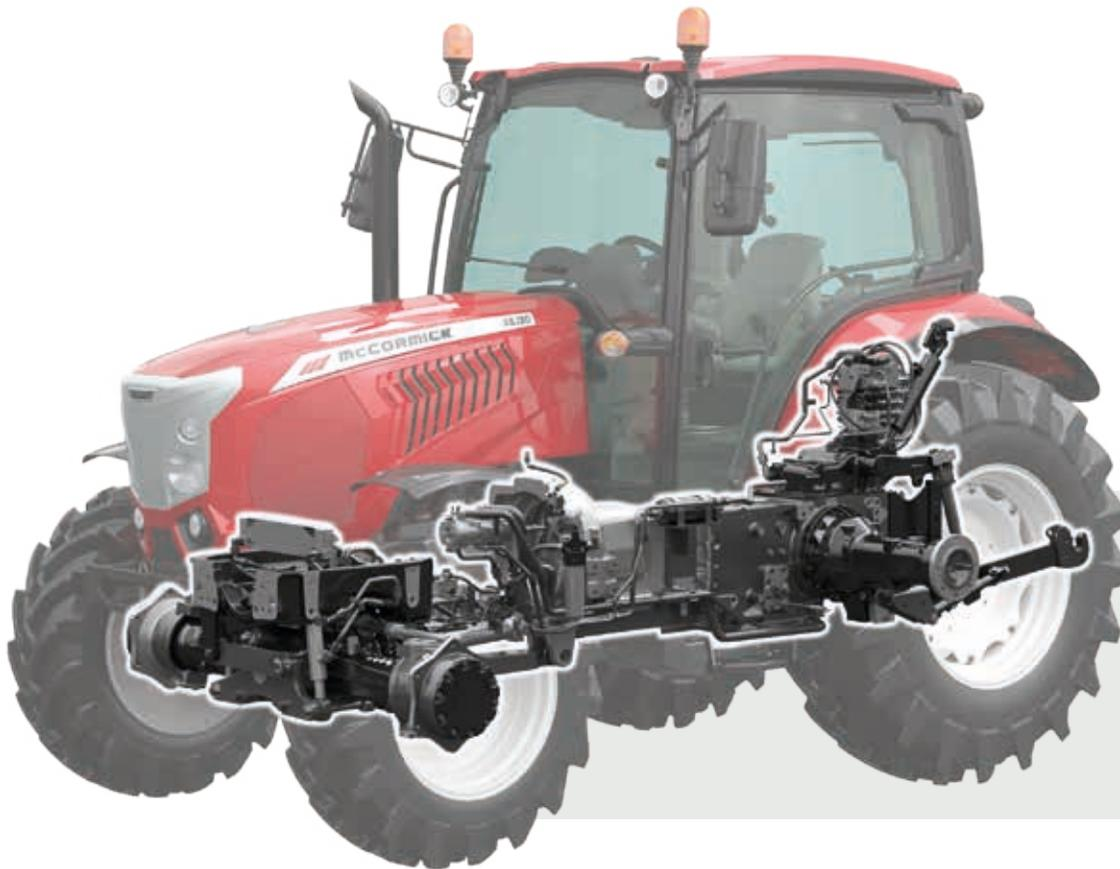
Le **X5** est équipé d'un circuit hydraulique à centre ouvert avec une pompe de 62 l/min ou 82 l/min, dédiée aux distributeurs, aux relevages et au chargeur. Une seconde pompe de 32 l/min est réservée à la direction. Cette puissante capacité hydraulique permet de :
