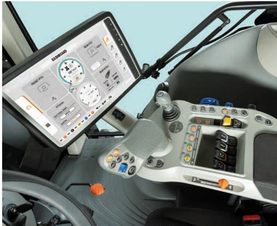
La gamme **X7 SWB** est équipée de la cabine Première Cab, spacieuse et confortable. Cette cabine de nouvelle conception, grâce à sa structure à 4 montants, offre une visibilité totale à 360° qui réduit la nécessité de se déplacer pour vérifier les angles morts. Les portes articulées à l'arrière augmentent encore la visibilité. L'excellente insonorisation (jusqu'à 70 dB) crée un environnement de travail très confortable.
